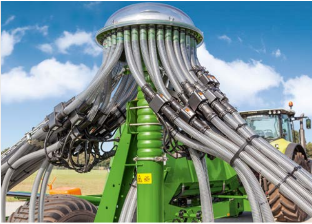
✔ Surveillance des descentes d'alimentation
